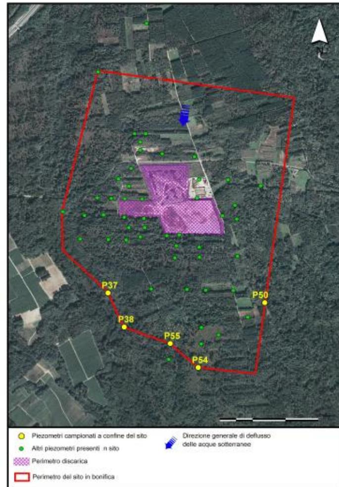
Fig. 1: Piezometri a confine del sito "Aree adiacenti la discarica di Ghemme" oggetto di campionamento.
